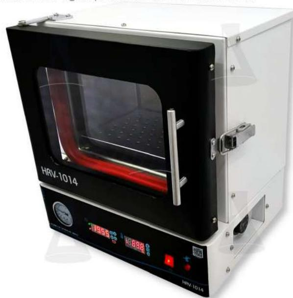
Nivel de vacío de 0 - 30" pulg/Hg
